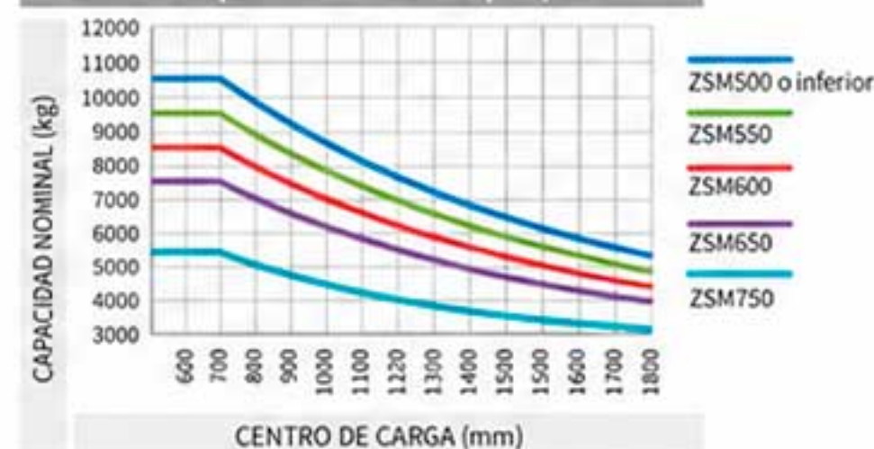
Curva de capacidad — mástil triplex, 12 t
